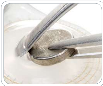
Abbildung 11 Einsetzen des temporären nicht-magnetischen Dummies mithilfe des Elevatoriums n. Freer und der Pinzette
