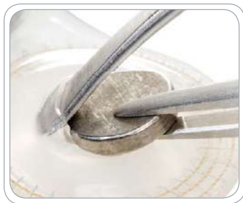
11 pav. Laikinas nemagnetinis kamštelis įstatomas keltuvu ir žnyplėmis.
