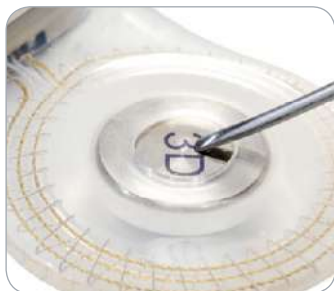
9. ábra A mágnes szilikontasakjának vizsgálata – nem látható sérülés (az elszakadt vagy kiharadt szilikon egyértelműen észrevehető).
