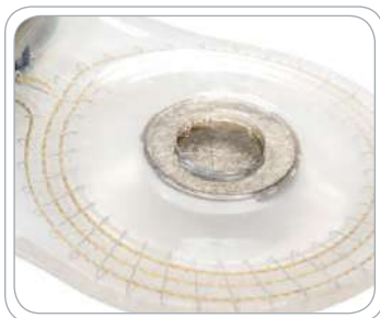
Figur 13. Kontrolleret magnetflomme i silikone – ingen skader fundet (ødelagt eller knækket silikone ses tydeligt).
