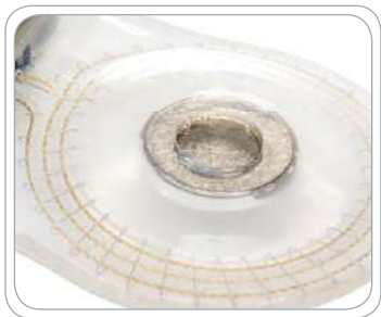
图 13. 检查磁铁硅胶填袋 – 不能出现损坏（硅胶没有明显撕裂或分离）。
