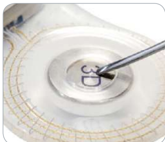
図9 シリコンのマグネット・ポ ケットを検査。損傷がない ことを確認(シリコンが破 れたり割れたりしている場 合はすぐに分かる)。
