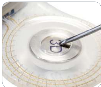
Figura 9. Bolsa de silicone do íman inspecionada – Sem danos verificados (rupturas ou fendas no silicone são óbvias).
