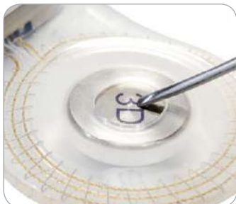
Kuva 9 Magneetin silikonitasku tarkastettu ja vauriottomuus varmistettu (repeytynyt tai haljennut silikoni näkyisi selvästi).
