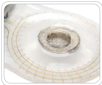
תרשים 13. בדיקת כיס הסיליקון של המגנט - נמצא תקין (קל להבחין בסיליקון קרוע או מפוצל).
