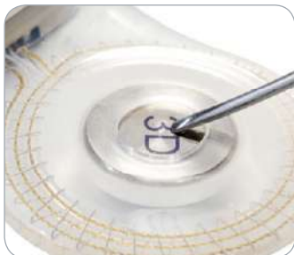
Bild 9 Magnetens silikonficka besiktigad – Inga skador har verifierats (trasigt eller sprucket silikon är uppenbart).
