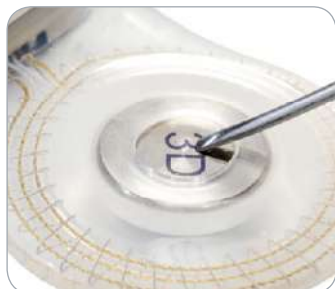
Figura 9. Tasca del magnete in silicone controllata: nessun danno rilevato (eventuali fessure o strappi nel silicone sono evidenti).
