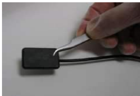
Không sử dụng kẹp để giữ cảm biến
