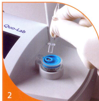
2 Ấn giọt hóa chất vào ống bằng cách đảo ngược dụng cụ lấy mẫu lại
